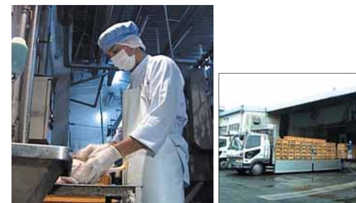
入荷したニワトリはまず外形でチェックし、60℃のお湯を使いながら羽をむしり取ります。熱に弱いインフルエンザウイルスの特性がここでも効果を発揮します。
